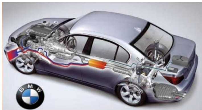
Obr. 2.1: Výroba elektrické energie termoelektrickým generátorem využíváním teploty výfukového systému automobilu [převzato z 3]
