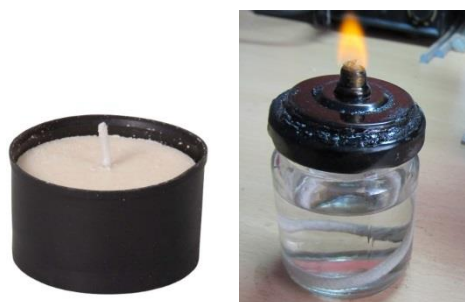
Obr. 6.2: Zdroje tepla používané při testování – iluminační svíčka (vlevo) a malý lihový kahan
